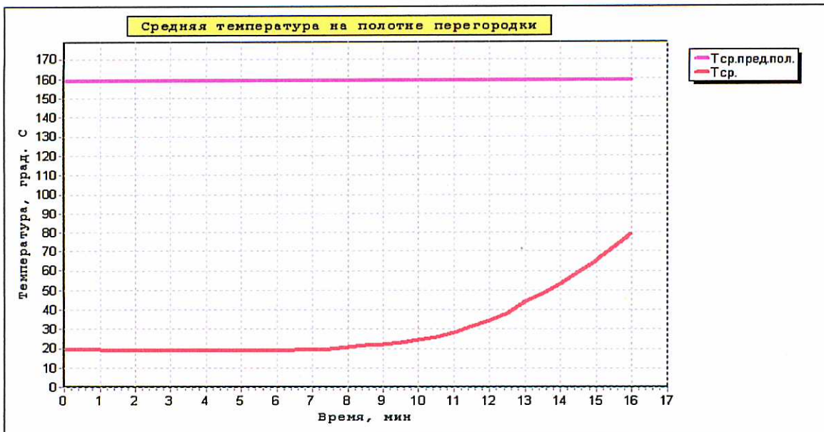
Рис. 13. График среднего значения температуры на необогреваемой поверхности перегородки.
