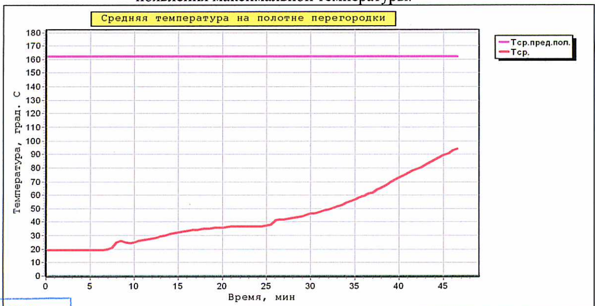
Рис. 21. График среднего значения температуры на необогреваемой поверхности перегородки.
